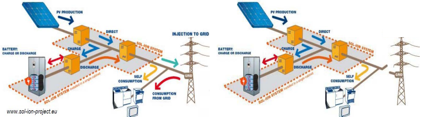
Abbildung 1: Sol-ion System mit zwei DC/DC Wandlern zum PV Generator und zur Batterie, sowie einem PV Generator für den Wechselstromanschluss, dargestellt in zwei Anwendungskonfigurationen
