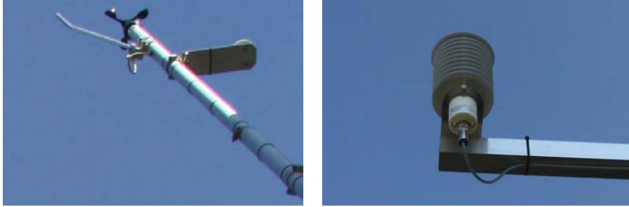
Abb. 3: Wettermessstation (Wind, Globalstrahlung, Temperatur) im Projektgebiet
