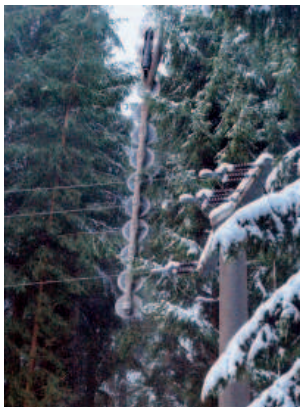
Die 400 Kilo schwere Vertikalsäge im Einsatz
